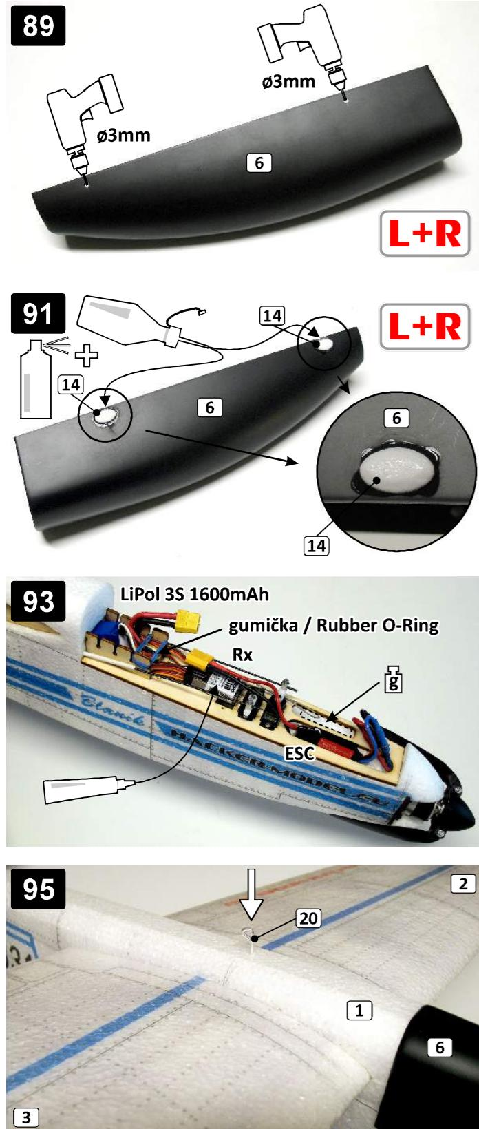
Stavba vašeho BLANÍKA je u konce. Regulátor zapojte tak aby se vrtule točila ve správném směru. Ve vysílači nastavte správnou velikost a orientaci výchylek a v případě pokročilého nastavení také jednotlivé mixy. Správné velikosti výchylek nastavte při záletu. Pohonnou baterii umístěte s ohledem na těžiště a zajistěte ji proti pohybu gumičkami. Pokud je to potřeba model dovažte přidáním zátěže vpředu nebo vzadu. Nelétejte extrémní akrobacii s běžícím motorem!
